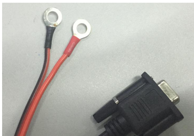
图 4 圆形端子和 DB9 接头
