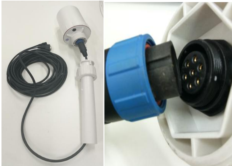
图 2-6 多卡型通信终端与北斗线缆连接示意图
