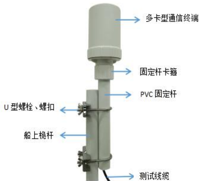
图 2-7 多卡型通信终端与桅杆安装示意图
